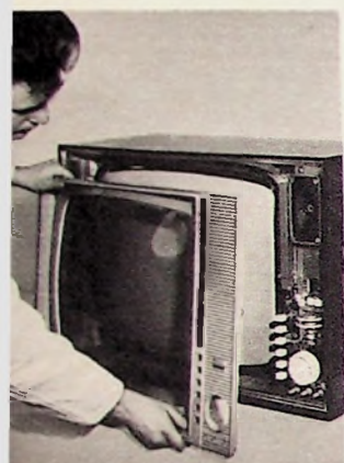
7. Nach vorn abnehmbare Frontabdeckung mit Schutzscheibe beim „FE 251“
